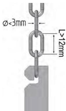
L'installation suspendue s'effectue en utilisant les étriers fournis. Il faut prévoir 3 chaînes de support auxquelles suspendre l'appareil.
