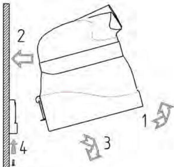
Une fois l'étrier fixé au mur avec les quatre vis, exécuter les quatre opérations suivantes comme indiqué ci-contre:
