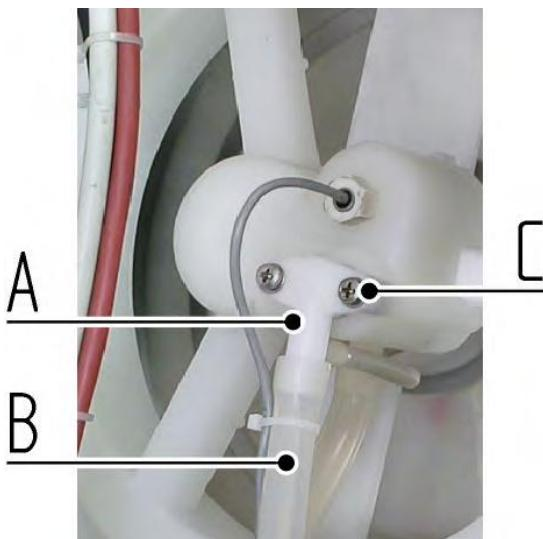
Il peut être nécessaire de nettoyer périodiquement le siphon d'évacuation A (voir ci-contre) : l'accumulation de saleté dans le siphon peut compromettre son fonctionnement correct.
