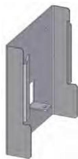
Pour installer l'appareil sur le mur, utiliser l'étrier et les quatre chevilles fournis. L'étrier peut être utilisé comme gabarit pour marquer les points de perçage sur le mur. Respecter les distances, comme indiqué dans le paragraphe 3.3, et, avant de percer, s'assurer que l'étrier est de niveau. S'assurer que le mur peut soutenir l'appareil en conditions de fonctionnement.
