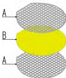
Le filtre doit être nettoyé périodiquement, car l'accumulation de salissures et de poussière réduit le débit d'air et, en conséquence, l'efficacité de la machine.
