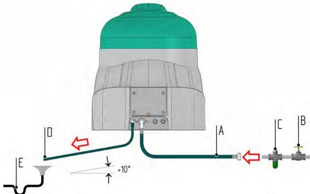
Le tuyau d'alimentation A, fourni de série, est muni aux deux extrémités d'une bague filetée G 3/4": raccorder l'extrémité libre (celle droite) directement à un robinet B, ou à une rallonge. Il est conseillé d'installer un filtre mécanique C en aval du robinet B, de la façon indiquée ci-dessus.
