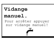
La tension de chauffage est interrompue et la pompe de rinçage démarre. Dès que le rinçage manuel est en cours, les trois LED s'allument successivement.
