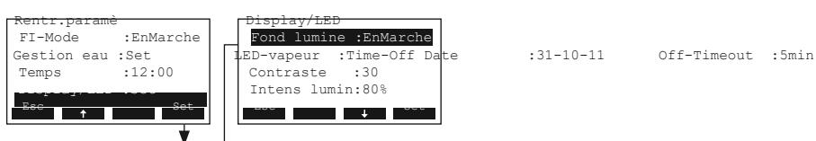
Le sous-menu pour la configuration de l'affichage apparaît. Sélectionnez les divers réglages avec les touches <↓> et <↑>. Les chapitres suivants donnent de plus amples informations au sujet des divers réglages.
