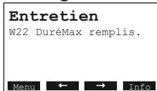
L'asservissement de l'appareil vérifie s'il s'agit d'un dérangement transitoire (par ex., brève interruption de l'alimentation en eau) ou si le dérangement se dépanne de soi-même par des prises de mesures adéquates. Si la cause du dérangement disparaît de soi ou si l'asservissement est en mesure de remédier au dérangement, le message d'alerte est supprimé automatiquement. Si le dérangement persiste encore après une période prolongée, un message d'erreur est déclenché.
